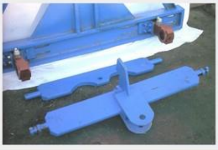
Mérőkeret a mérőcellákkal
